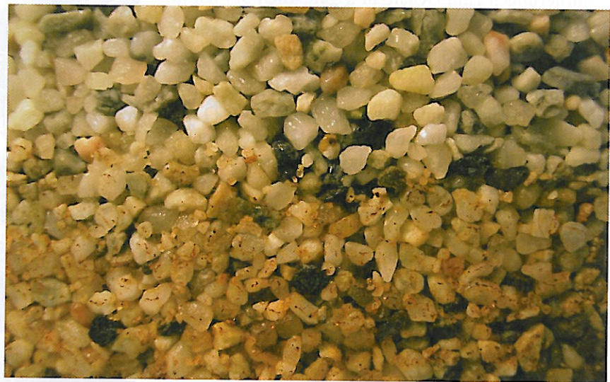
Abb. 5 Ausbildung des Kolmationshorizontes in Filterversuchen
